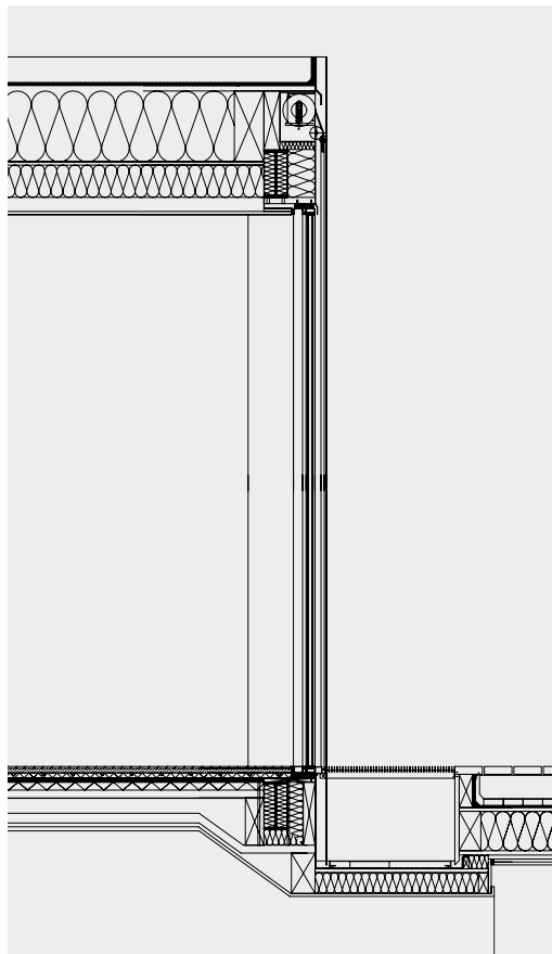
Vertikalschnitt: boden- und deckenbündig eingebautes Schiebefenster „Sky-Frame“
